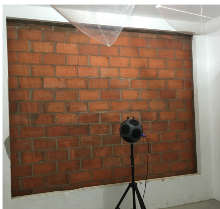
Figura 2 – Amostra no interior da câmara para ensaios de perda de transmissão sonora
