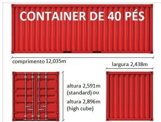
Figura 2 – Dimensões de container de 40 pés. Fonte http://dicasdearquitetura.com.br/tipos-e-medidas-de-containers-para-construcao/
