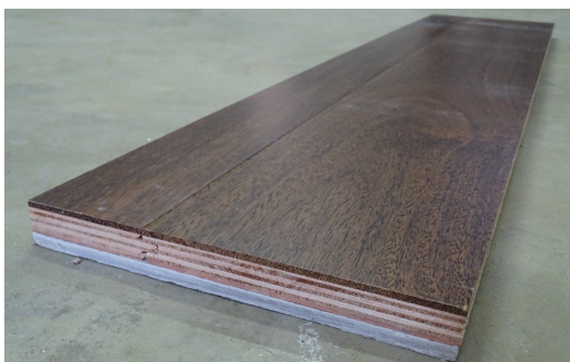
Foto 1: Corpo de prova para ensaio (em revestimento de piso) de fluxo crítico de energia radiante
