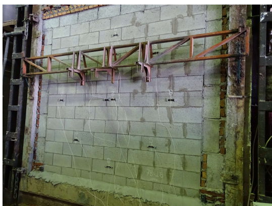
Foto 2: Ensaio de resistência ao fogo em parede sem função estrutural
