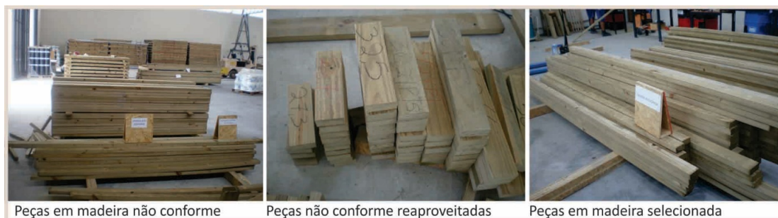
Figura 3 – Controle de qualidade da madeira recebida na fábrica
