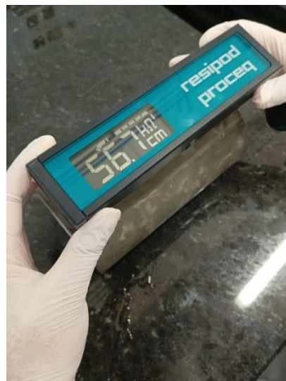
Figura 10: Ensaio sendo realizado com o equipamento Resipod.
