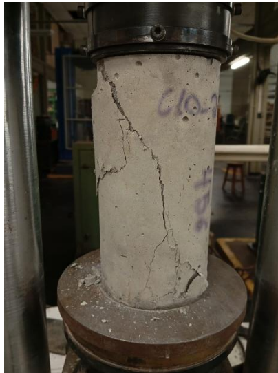
Figura 8: Corpo de prova colapsado após o ensaio.
