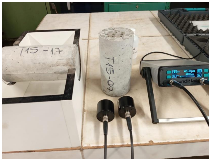
Figura 2: Realização do ensaio de VPU.
