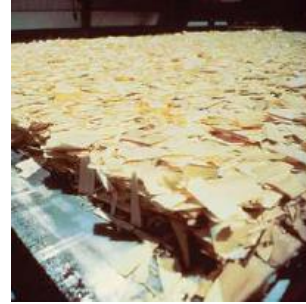
Figura 2: Vista real de um painel OSB com fibras orientadas durante o processo de fabricação.
