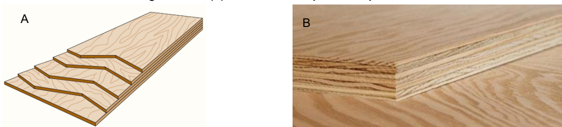
Figura 3: Estrutura interna de painéis compensados: (A) Ilustração esquemática da disposição cruzada das lâminas de madeira em ângulos retos (B) Vista real de um painel compensado.
