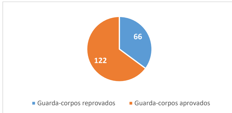
Figura 16: Quantidade de guarda-corpos reprovados do total de 188 ensaiados
